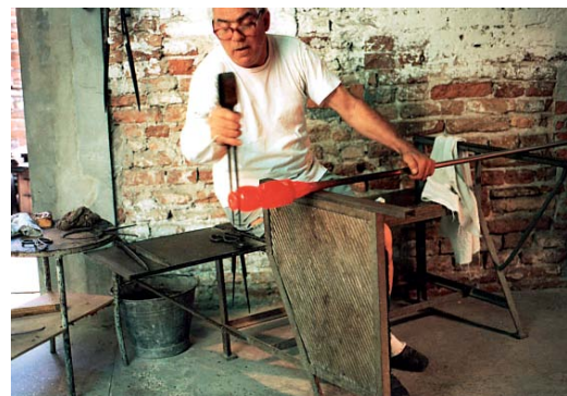
Figura 2. Proceso de modelado de una pieza soplada
