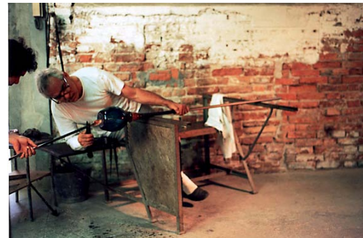
Figura 4. Aplicación del puntel
